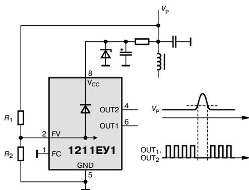
**Рис. 6.** Схема защиты выходного каскада по напряжению
