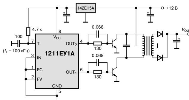
**Рис. 11.** Схема преобразователя напряжения с использованием 1211EУ1А и биполярных транзисторов
