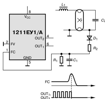
**Рис. 7.** Схема защиты выходного каскада по току
