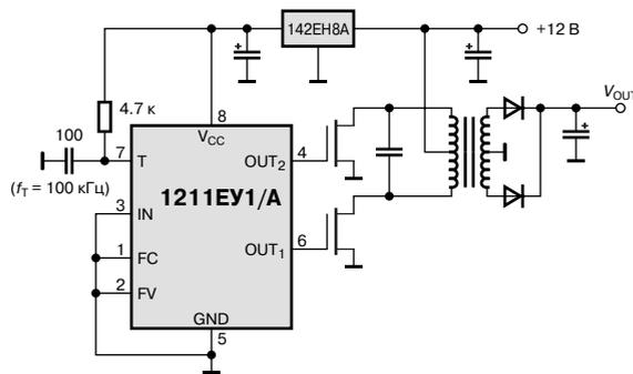
**Рис. 10.** Схема преобразователя напряжения мощностью 15 Вт
